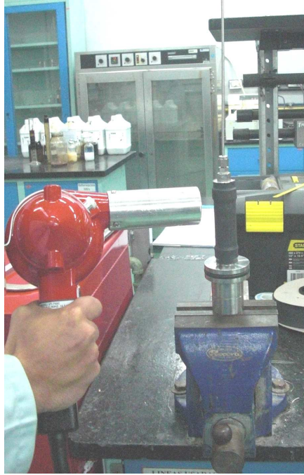
Figura 44: Deformación térmica núcleo concluido.
